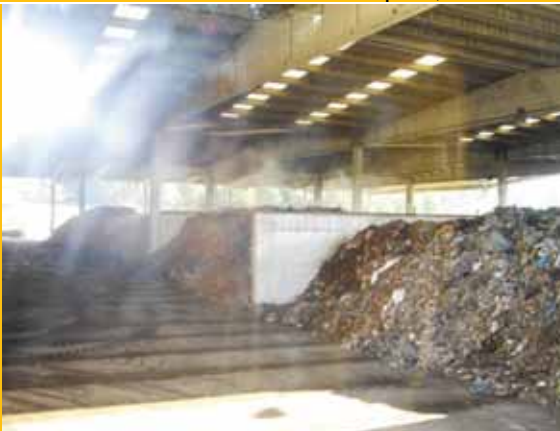
Planta mecanizada de compost con piso ventilado, Manresa, El Bages, Catalunya
