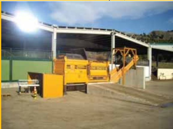
Planta mecanizada de compost con piso ventilado, Manresa, El Bages, Catalunya
