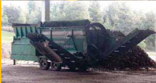
Trómel intermedio de malla grande para separación de impropios
