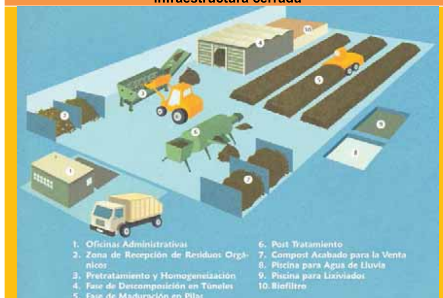
Figura 6.13: Ejemplo Planta de compostaje mecanizada con infraestructura cerrada
