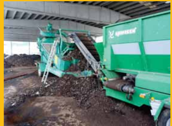
Trómel final de refinó con mesa densimétrica para separación de impropios
